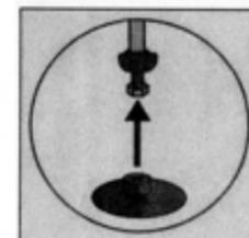
DE: Bringen Sie die Abschlusskappen (D) oben auf den Teleskopstangen (C) an. Am Ende der Teleskopstangen (C) finden Sie je einen Bolzen. Drehen Sie jeden Bolzen etwa 2-3 Zentimeter heraus und stecken Sie die Gummi-FüÙe (E) auf die Bolzen (siehe Abbildung).
